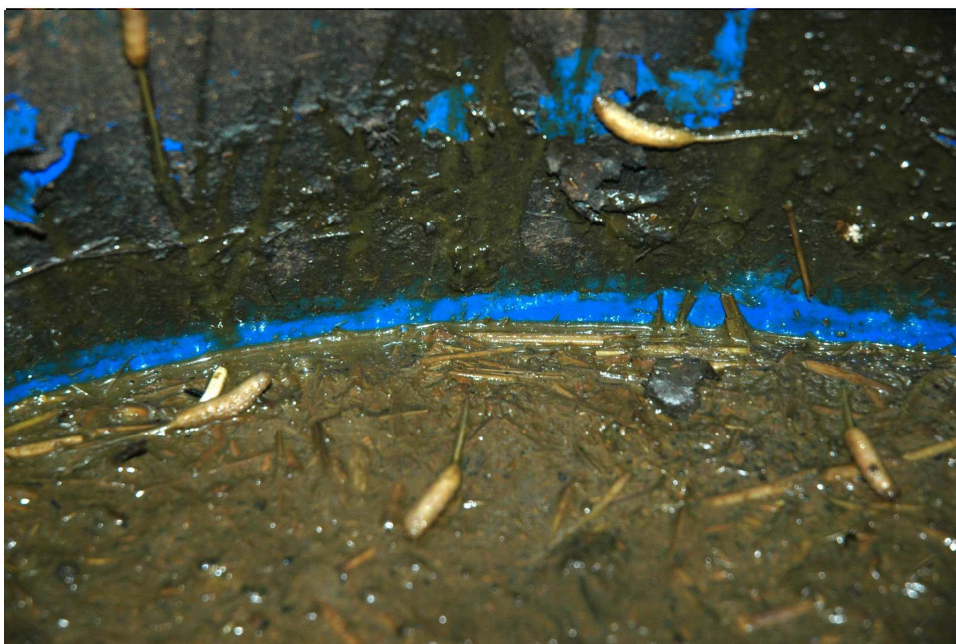
Lisier anaérobie en cours de test à l'université de Sherbrooke au Canada. On voit nettement les bulles de gaz et les larves d'insectes.
